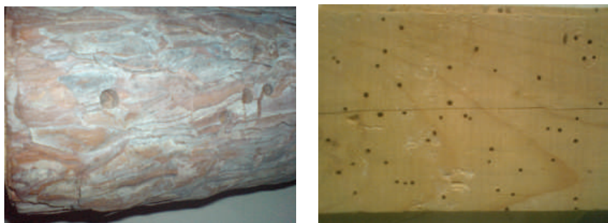
Сл. 11. Влезни и излетни отвори кај ксилофагните инсекти: а. оси дрвенарки и б. дрвоточци (ориг.)
